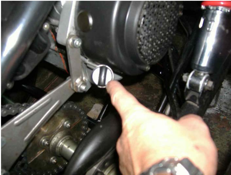
Zündkerze Elektrodenabstand überprüfen / oder wechseln
